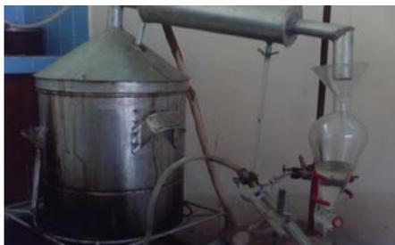
Gambar 1. Proses Destilasi Pada Kulit Batang Gemor.
